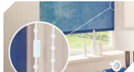
索鏈斷開連接器將在任何過度負載下分離，但經過檢查之後可以重新連接
